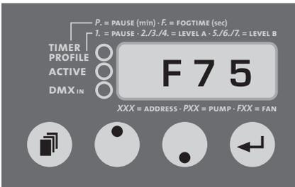
Fig. 2: Réglage du débit du ventilateur (Fan)
