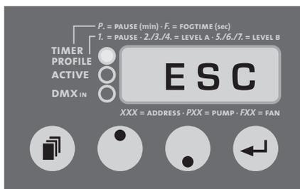
Fig. 14: Escape pour retourner dans le menu standard
