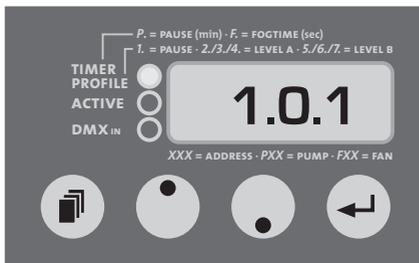
Fig. 6: Réglage du temps de pause (Pre-Run time)
